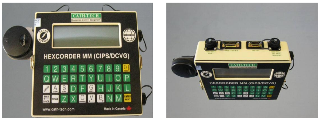
Рис. 2. Цифровой универсальный прибор «Hexcorder MM» производства Cathodic Technology Ltd. для выполнения ГНПТ/МВЭ обследования
